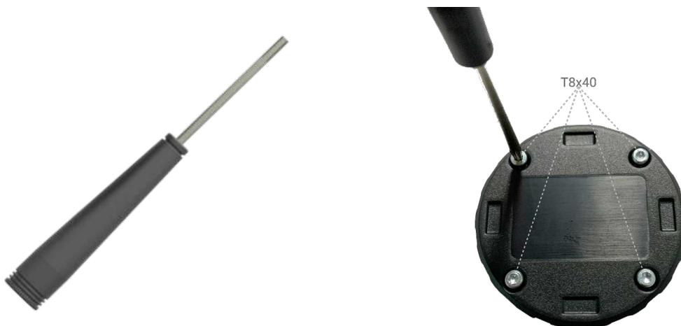
Entfernen Sie vorsichtig die hintere Abdeckung der Fernbedienung. Achten Sie darauf, dass die Leiterplatte nicht aus dem Gehäuse fällt und entnehmen Sie die Batterie.
