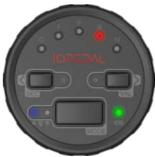
Aktivieren Sie die Fernbedienung und überprüfen Sie den Verbindungsstatus. Die Connection-Anzeige sollte jetzt blau leuchten.
