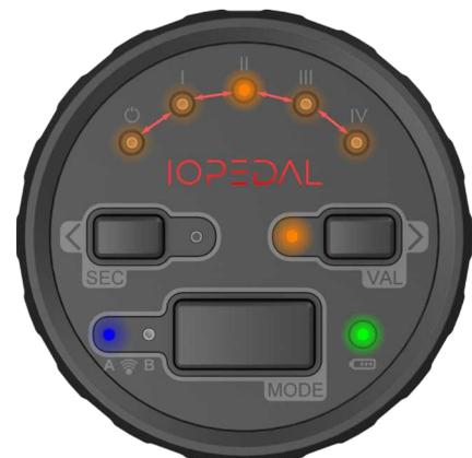
orange zu blinken. Die oberen 5 LEDs zeigen jetzt die Feinabstimmung der Valet-Funktion an. Die linke Taste verringert und die rechte Taste erhöht die Leistung.
